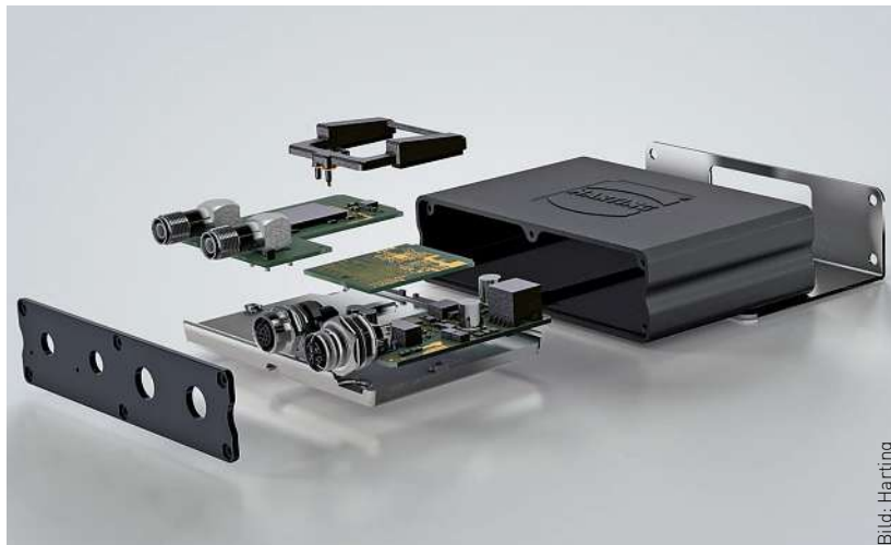
Der Mini-Industrie-PC Mica ist modular aufgebaut.
