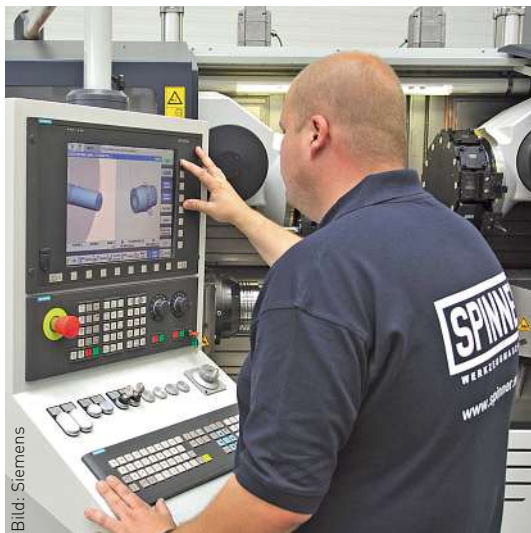
Bei der Fertigung großer Serien sind optimale Bearbeitungsabläufe entscheidend. Dementsprechend werden die Programme für die Spinner TTS primär im Programguide geschrieben.
