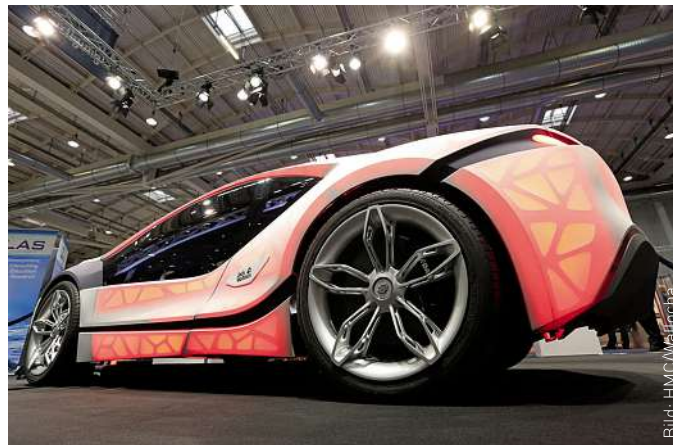
Ein Besuchermagnet auf der diesjährigen Nortec war die Sonderschau 3D-Druck. Der Hingucker dort war das spektakuläre Concept-Car „Light Cocoon“ mit seiner Karosserie aus dem 3D-Drucker.
